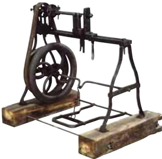
伊藤嘉平治が開発した足踏み式旋盤（複製）。
