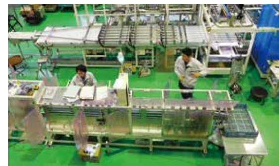
食品工場からの依頼でカスタムメイドした、 パック商品を3段に積み重ねる装置
